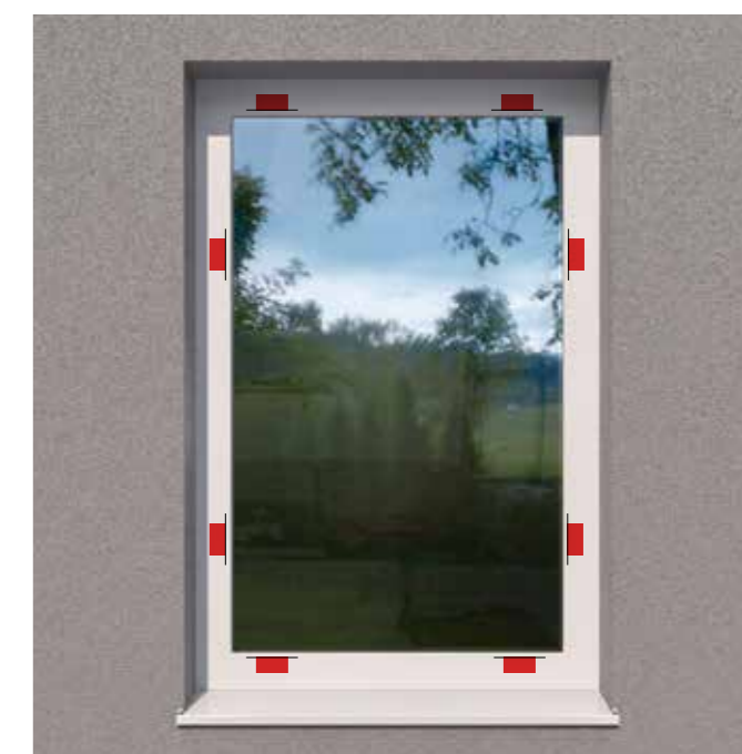
Standardní uspořádání zamykacích bodů I-tec Secure
